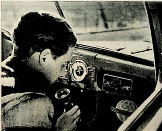
Betriebszentrale und Übertragungsstell besteht, während die Fahrzeuganlage für die Streifenwagen den Funkgerätesatz (Sender/Empfänger), Gleichrichter und Zubehör, Bedienungsgerät zum Einbau in das Armaturenbrett, Handhörer und Stabantenne umfaßt.
